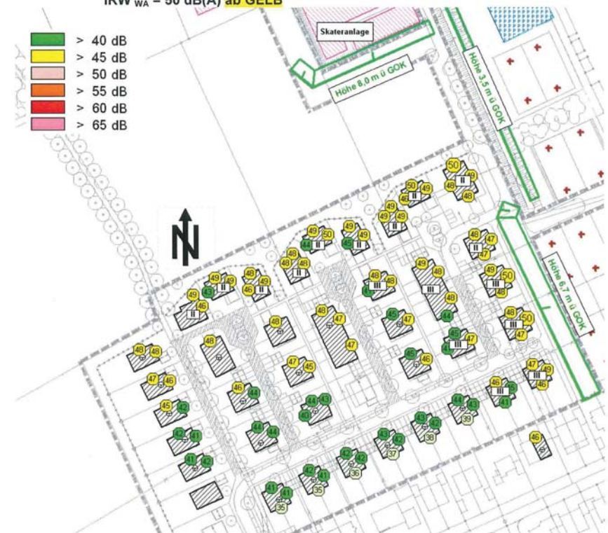
Abbildung 6 Immissionsbelastung in der Ruhezeit durch die Sportanlagen (Tennis, Skateranlage und Fußball mit Vereinsgaststätte und Parkplatz) mit der notwendigen Abschirmung IRW WA = 50 dB(A) ab GELB
