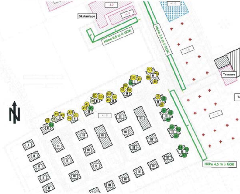
Abbildung 7 Immissionsbelastung im Erdgeschoss (2,5 m über GOK) mit der 6,5 bzw. 4,5 m hohen Maßnahme IRW WA = 50 dB(A) ab GELB
